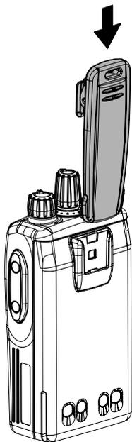
❑ Para remover a mola de cinto: utilize uma chave de fendas de cabeça chata para pressionar e desbloquear a patilha da mola de cinto da bateria e, em seguida, faça deslizar a mola de cinto para cima para removê-la.
