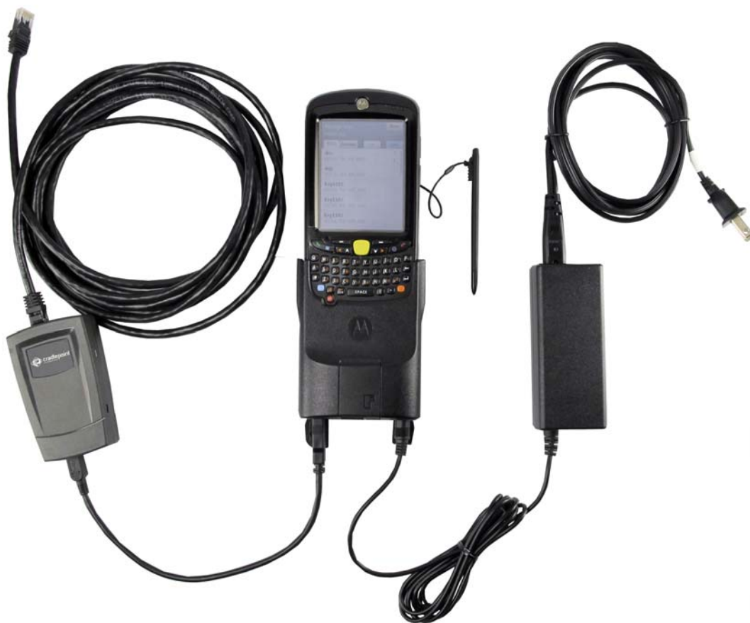
Figura 1-9 KVL y Adaptador USB a Ethernet: conectados
