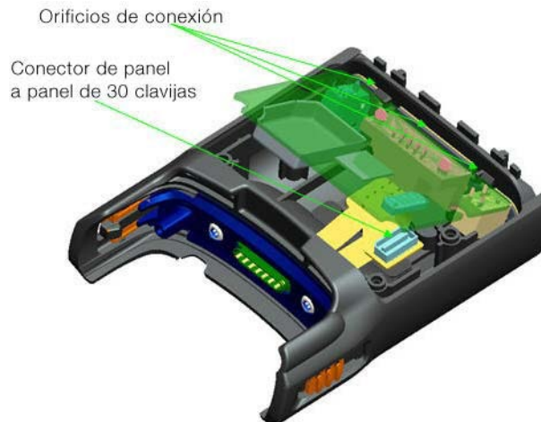
Figura 7-6 Retirar el conjunto del PCB
