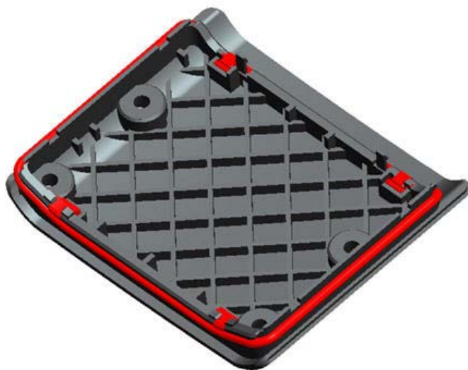
Figura 7-12 Carcasa posterior: armada
