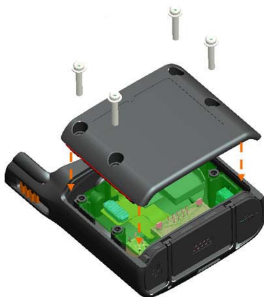
Figura 7-18 Armado de la carcasa posterior en la carcasa delantera
