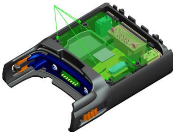
Figura 7-15 Armado de la carcasa delantera: PCB puesta
