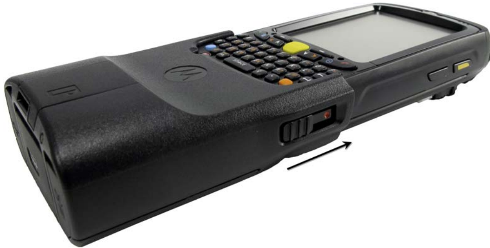
Figura 1-6 PDA y Adaptador de seguridad: conectados
