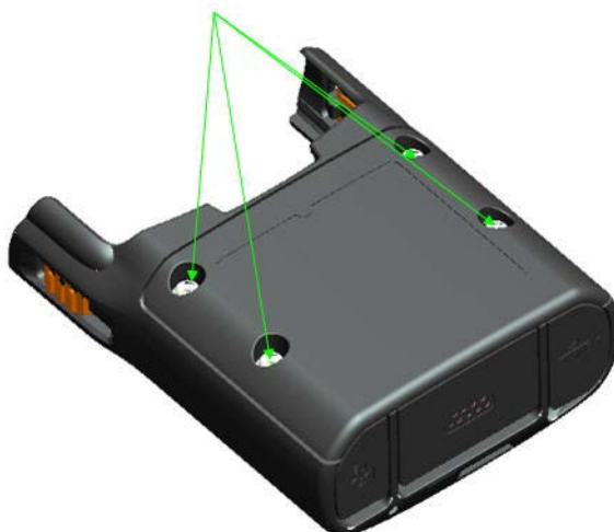
Figura 7-19 Apretar la carcasa posterior
