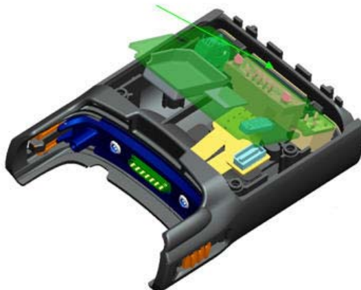
Figura 7-14 Armado de la carcasa delantera: conectores
