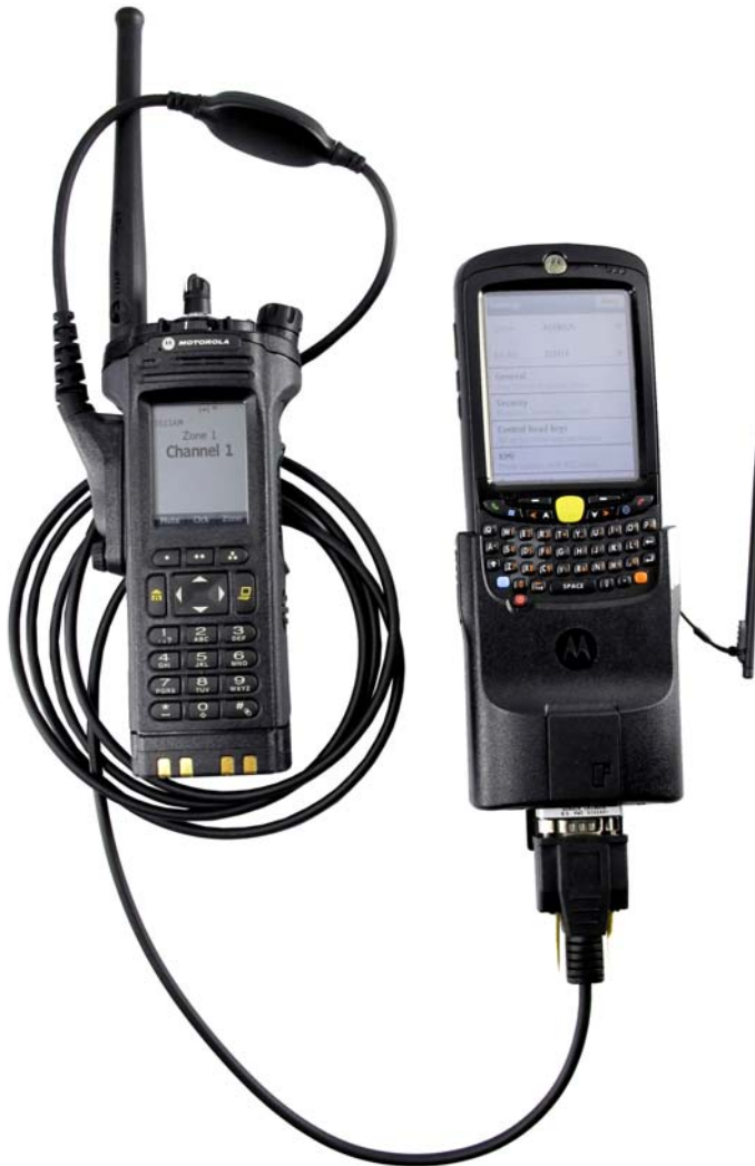
Figura 1-7 KVL y una radio portátil: conectados (ejemplo)
