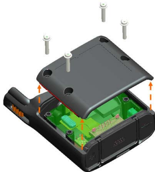
Figura 7-4 Retirar la carcasa posterior
