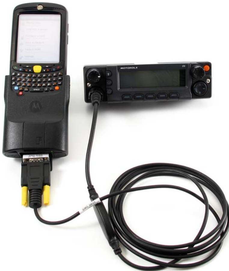
Figura 1-8 KVL y una radio móvil: conectados (ejemplo)
