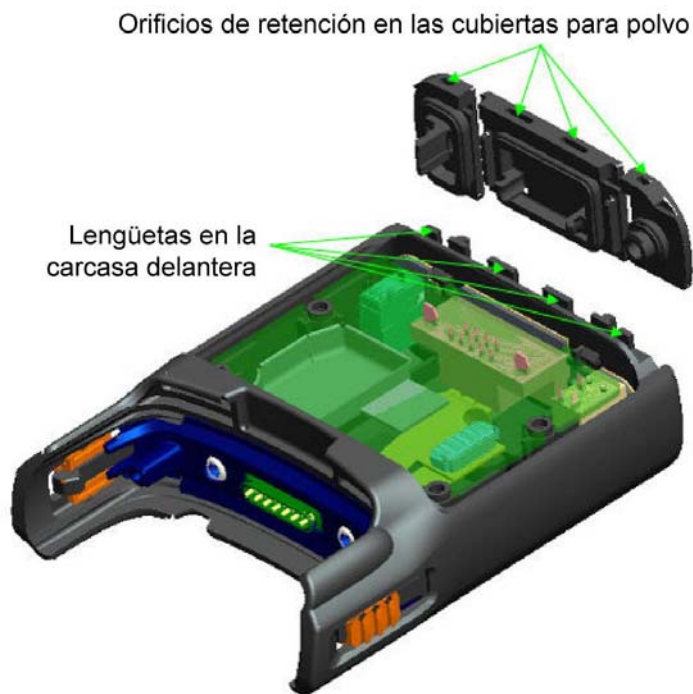
Figura 7-16 Montaje de los cubre polvos
