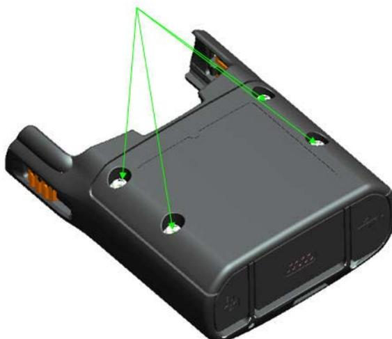
**Procedimiento 9-5** Cómo armar el Adaptador de seguridad (Continuación)
