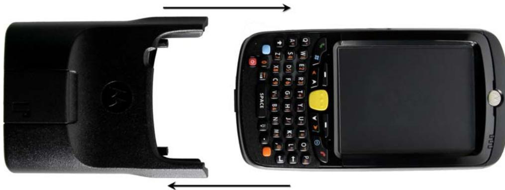
Para asegurar el Adaptador, deslice completamente las lengüetas de bloqueo hasta que sienta un clic que indica que están en la posición bloqueada. Si alguna lengüeta no está en la posición bloqueada, se ve un punto naranja, como se muestra en [Figura 1-8](#).
