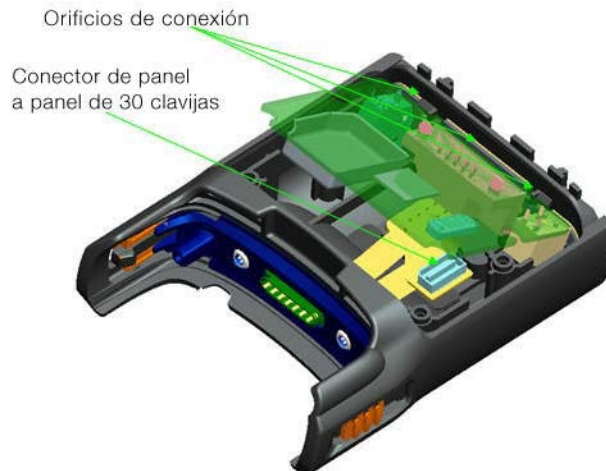
Figura 12-6 Retirar el conjunto del PCB
