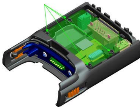
Figura 12-15 Armado de la carcasa delantera: PCB puesta
