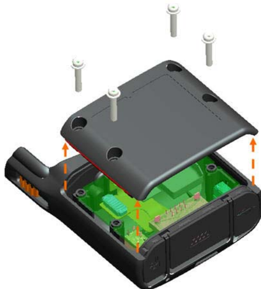
Figura 12-4 Retirar la carcasa posterior
