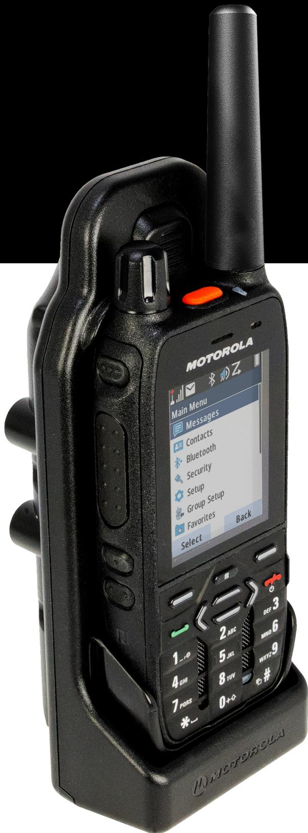
Le kit de voiture pour MXP600 est un adaptateur conçu pour transformer votre portatif MXP600 en un mobile virtuel. Il permet de recharger la batterie dans un véhicule, de bénéficier d'un mode mains libres et d'une couverture étendue.
