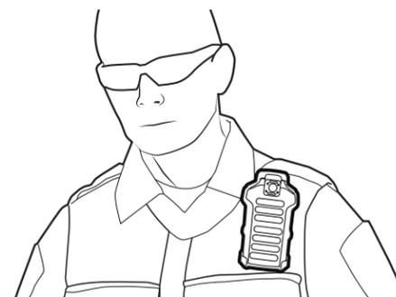
2. Se usa en el centro del pecho (en vertical o con rotación de 90 grados aproximadamente) con la cabeza inclinada para que la boca quede en dirección a las matrices del micrófono.
