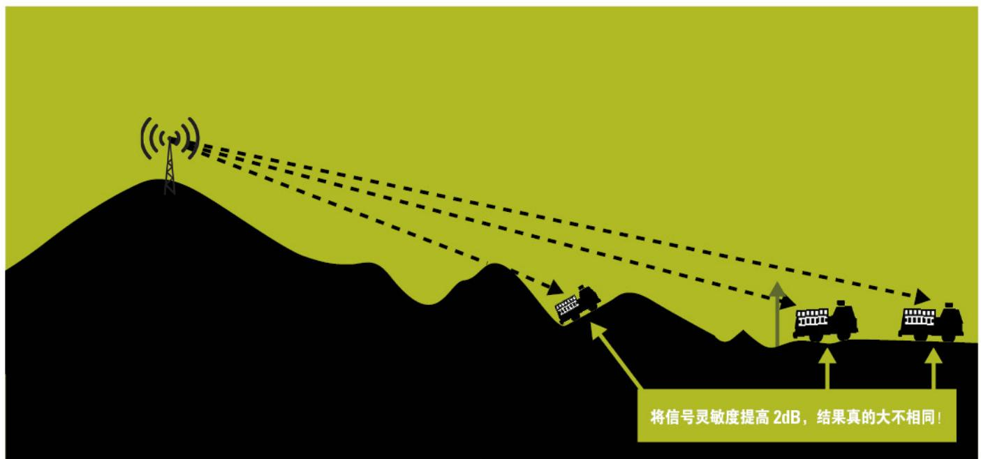
利用由 Hata 和 Okumura 传播模型推导出的路径损耗公式，可以预计系统的“典型”传输距离。该传播模型基于在日本进行的实地测量结果，可用于预测蜂窝系统传输性能。这些经验公式，是公认用于预测系统传输距离的方法。如果采用 Hata 郊区或城市模型，那么，路径损耗降低 2dB，传输距离可以延长 14%，或者覆盖范围扩大 30%。在实际工程中，规划工具给出的实际改善结果更加乐观（请参阅前文），无疑，这表明了 2dB 巨大的改善潜力。
