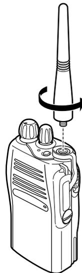
Dévissez l'antenne dans le sens inverse des aiguilles d'une montre pour la retirer.
