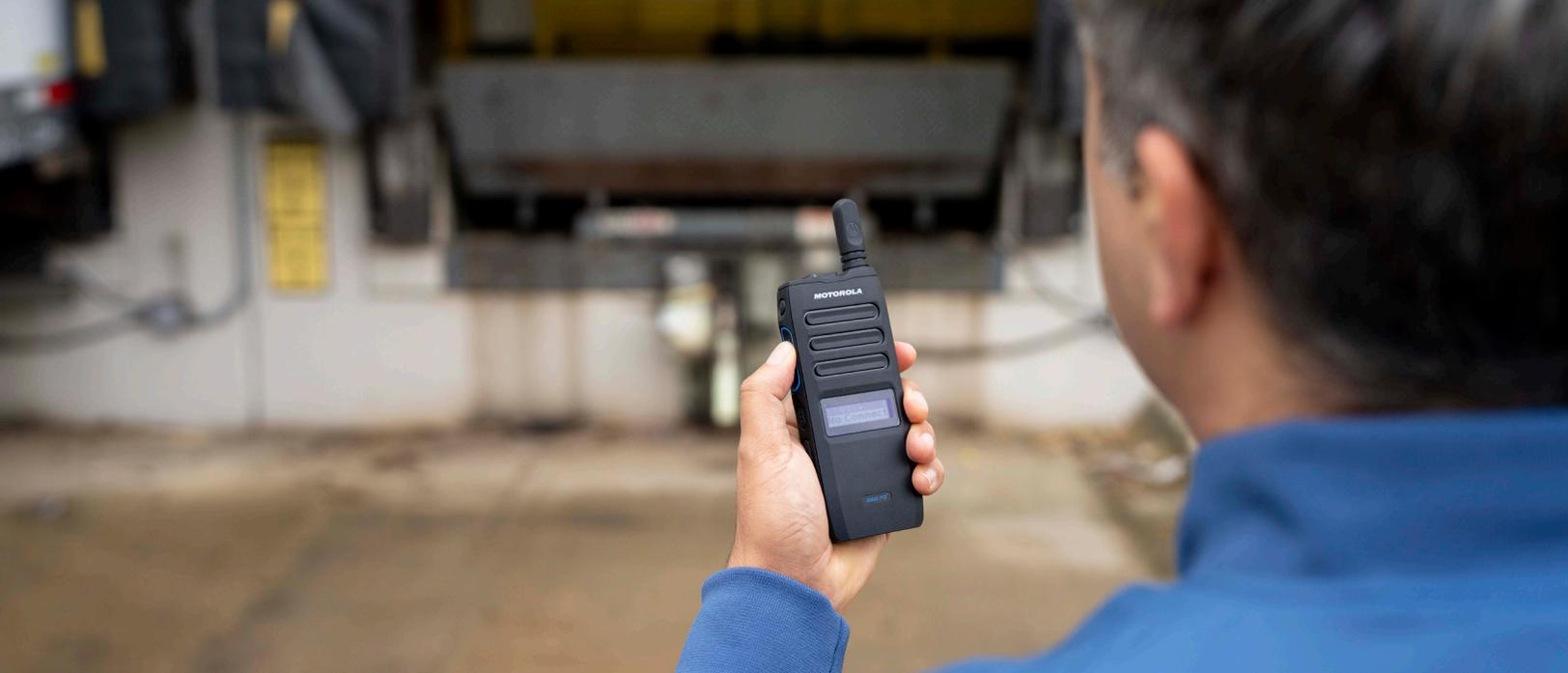
Cuando la función Alerta de caída está activada, el dispositivo TLK 110 utiliza un acelerómetro para determinar si el dispositivo está en un ángulo "inusual" o si se detuvo el movimiento. El TLK 110 emitirá un tono de advertencia previa para pedirle al usuario que vuelva a colocar el dispositivo en una posición normal y, si no se corrige el ángulo, el TLK 110 y la aplicación WAVE PTX iniciará automáticamente una llamada de emergencia.
